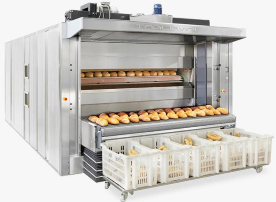
**STEAM TUBES MULTI DECK – AUTOMATIC TUNNEL OVEN**
