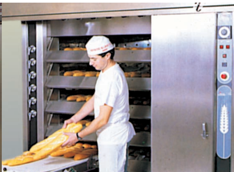
Carga y descarga mediante cargador de columna automático puerta a puerta. Loading and unloading by automatic column loader door-to-door. Fournement et unfournement par enfourneur automatique à colonne bouche par bouche.
